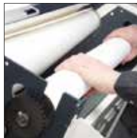
Tapis de façonnage Changement ultra-rapide des tapis sans démontage de la machine.
